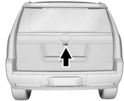
La cámara que proporciona la imagen de Espejo de cámara trasera (RCM) está arriba de la placa de circulación, junto a la Cámara de visión trasera (RVC).
