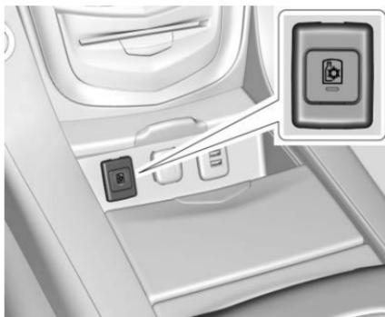
Si está equipado, oprima para encender el compartimento refrigerado en el almacenamiento de la consola central.
