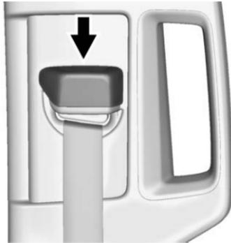
Presione hacia abajo el botón de liberación para mover el ajustador de altura a la posición deseada.
