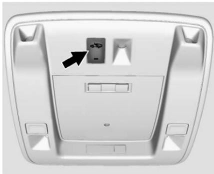
Se recomienda desactivar los sensores de intrusos e inclinación si hay mascotas presentes en el vehículo o si se va a transportar el vehículo.
