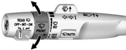
El control del limpiaparabrisas está en la palanca direccional.
