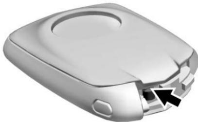
2. Separe las dos mitades del transmisor usando una herramienta plana insertada en el centro inferior del transmisor. No use la ranura de la llave.
