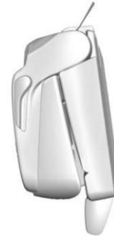
3. Levante la palanca de nuevo para liberar la parte trasera del asiento del piso. El asiento se abatirá hacia delante.
