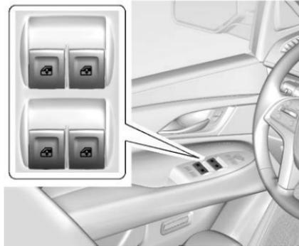
Las ventanas eléctricas funcionan cuando la ignición está en encendida, en ACC/ACCESSORY (Accesorios), o cuando la Energía retenida para los accesorios (RAP) está activa. Consulte *Energía retenida para los accesorios (RAP)* ⇨ 219.
