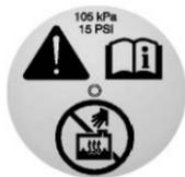
1. Retire el tapón de presión del tanque de compensación del refrigerante cuando el sistema de enfriamiento, incluyendo el tapón de presión del tanque de compensación del refrigerante y la manguera superior del radiador, ya no están calientes. Haga girar el tapón de presión lentamente una vuelta completa en sentido inverso al de las manecillas del reloj. Si escucha un silbido, espere hasta que desaparezca. El silbido indica que aún existe algo de presión.
