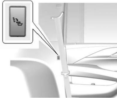
Interruptor del panel trasero del lado del conductor
