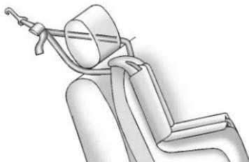
Si la posición que usa tiene un soporte de cabeza fijo o ajustable y está utilizando un amarre dual, dirija el amarre alrededor del soporte de cabeza ajustable.
