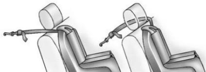
Si la posición que usa tiene un reposacabezas o cabecera fijos y está utilizando una correa sencilla, guía la correa alrededor del lado interno o del lado de la ventanilla del reposacabezas o cabecera.
