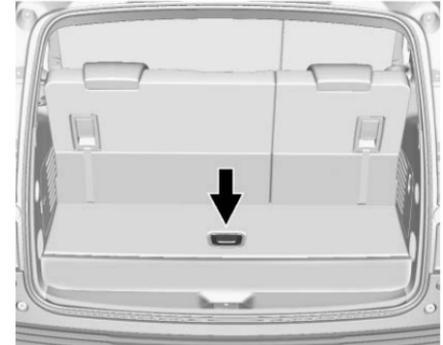
Hay almacenamiento en el piso del área de carga trasera. Levante la palanca para acceder. Hay una división removible para facilitar la organización.
