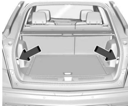
El vehículo tiene dos puntos de amarre de carga en el compartimiento posterior.
