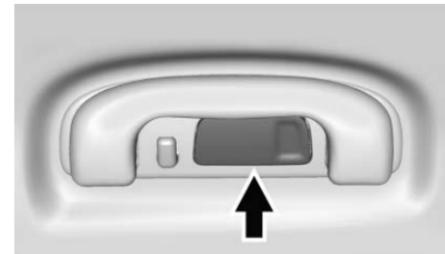
Oprima las lentes de la lámpara para encender o apagar las luces de lectura traseras.
