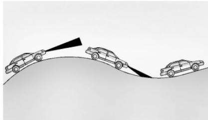
No utilice el ACC al conducir en colinas pronunciadas o al arrastrar un remolque, el ACC no detectará un vehículo en el carril al conducir en colinas pronunciadas. Si aplica los frenos, el ACC se desactiva.
