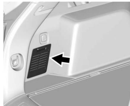
El bloque de fusibles del compartimiento trasero se encuentra en el área de carga, en el lado del conductor del vehículo, detrás del tablero de revestimiento inferior. Para abrir, haga girar el seguro con una herramienta de punta plana y jale del tablero de moldura desde los bordes para plegarlo hacia abajo.
