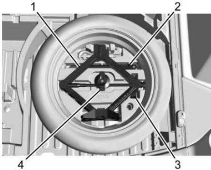
4. Gire la tuerca de mariposa (4) en sentido contrario al de las manecillas del reloj para remover el gato (1), llave para rueda (2), y correa (3). Coloque el gato y las herramientas cerca de la llanta que se va a cambiar.
