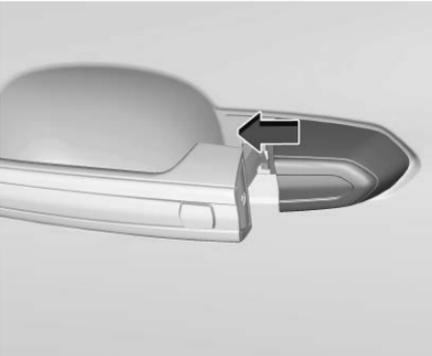
3. Deslice la tapa hacia el frente y presione el borde delantero para instalar la tapa en su lugar.
