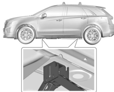
5. Coloque la cabeza de elevación del gato en el punto para colocación del gato que esté más cerca de la llanta que se va a cambiar. La ubicación para levantar con gato está indicada por medio de una muesca semicircular en el reborde metálico. El gato no debe usarse en ninguna otra posición.
