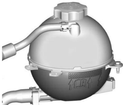
3. Llene el tanque de compensación del refrigerante con la mezcla apropiada hasta la marca indicada en la parte delantera del tanque de enfriamiento.
