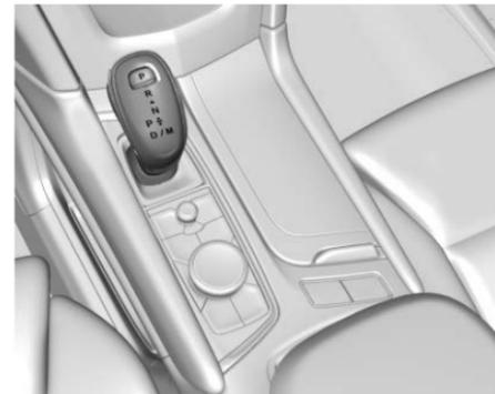
El patrón de cambios se muestra en la parte superior de la palanca de cambios. La posición de velocidad seleccionada se iluminará en rojo en la palanca de cambios, mientras que todas las demás se proyectarán en blanco. Si el cambio no es inmediato, como en condiciones muy frías, el indicador en la palanca de cambios puede parpadear hasta que esté completamente accionado.
