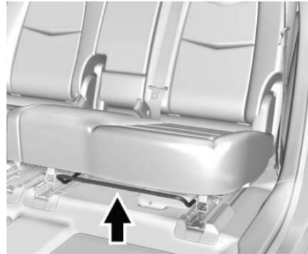
Para ajustar la posición del asiento, levante la palanca de debajo del cojín del asiento y deslice el asiento hacia adelante o hacia atrás.
