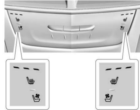
Si está equipado, los botones están cerca de los controles de clima en la columna central. Para que funcione, el motor debe estar encendido.
