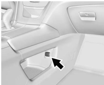
El vehículo tiene dos tomacorrientes para accesorios: uno en la consola de piso central inferior y uno en el área de carga trasera.
