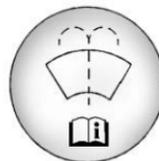
Abra el tapón que tiene el símbolo del lavaparabrisas. Agregue líquido para lavaparabrisas hasta llenar el tanque. Vea en *Vista general del compartimiento del motor* ⇨ 290 la ubicación del depósito.
