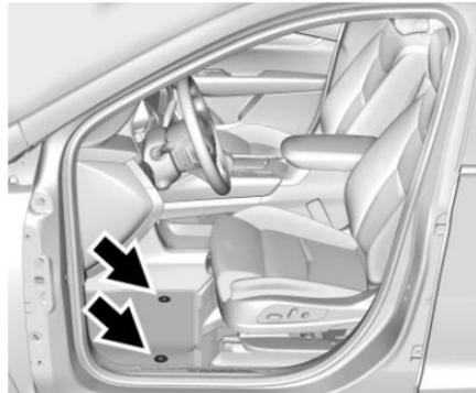
1. Tire hacia arriba de la parte trasera del tapete del lado del conductor para desacoplar cada uno de los retenes y retire el tapete.
