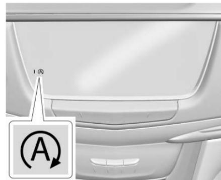
La función de paro/arranque automático del motor se puede desactivar y activar tocando el símbolo (A) en la columna central. El Paro automático se activa cada vez que arranca el vehículo.
