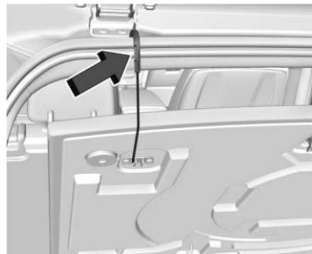
Retire el gancho del piso de carga del soporte y sujete a la cinta para intemperie arriba. Cuando termine, regrese el gancho del piso de carga al soporte.
