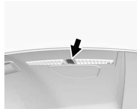
El sensor solar, arriba del tablero de instrumentos junto al parabrisas, monitorea el calor solar.
