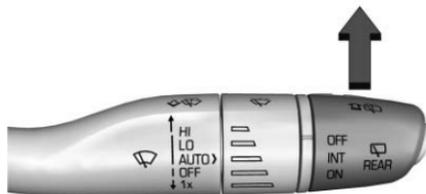
Si está equipado, empuje la palanca del limpiaparabrisas hacia adelante para rociar líquido en los lentes de la cámara trasera y de la cámara de Visión nocturna. La palanca vuelve a su posición inicial al soltarla. Vea *Espejo de la cámara trasera* ⇨ 31.
