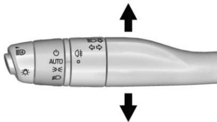
Mueva la palanca completamente hacia arriba o hacia abajo para señalar una vuelta.
