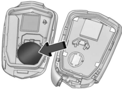
3. Retire la batería vieja. No utilice un objeto metálico.
