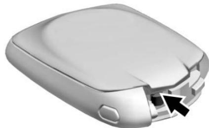
2. Separe las dos mitades de la llave remota usando una herramienta plana insertada en el centro inferior de la llave remota. No use la ranura de la llave.
