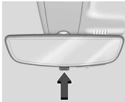
Jale la pestaña para activar la pantalla. Empuje la pestaña para apagarla. Cuando está apagado el espejo es de atenuación automática. Ajuste el espejo para una visión clara del área situada detrás del vehículo mientras la pantalla está apagada.
