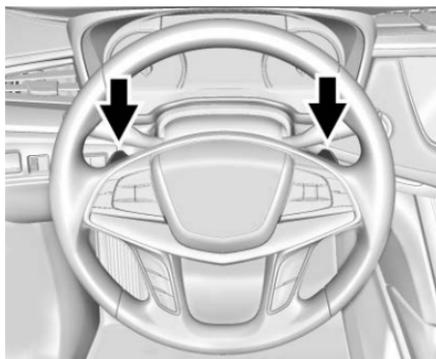
Si está equipado, los vehículos con Cambio manual tienen controles en la parte trasera del volante para cambiar manualmente la transmisión automática.
