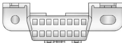
El DLC está debajo del tablero de instrumentos del lado izquierdo del volante. Conectar dispositivos que no se utilicen para realizar una Inspección de emisiones/Prueba de mantenimiento o para dar servicio al vehículo puede afectar la operación del vehículo. Vea *Equipo eléctrico incorporado* ⇨ 285. Visite a su distribuidor si necesita asistencia.
