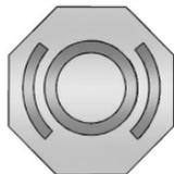
El depósito del cilindro maestro de frenos se llena con líquido de frenos DOT 4 aprobado por GM, como se indica en el tapón del depósito. Vea en *Vista general del compartimiento del motor* ⇨ 290 la ubicación del depósito.
