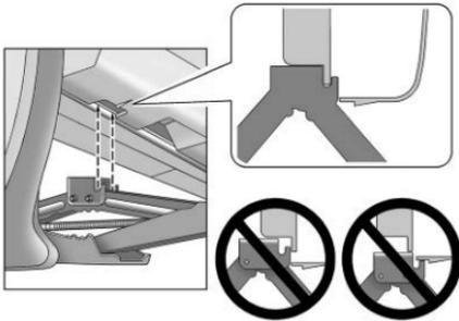
6. Gire la llave para ruedas en el sentido de las manecillas del reloj para levantar el gato hasta que la ranura en la cabeza de elevación del gato se coloque en el reborde metálico ubicado detrás del resaque en la moldura de plástico.
