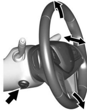
**Volante eléctrico inclinable y telescópico**
