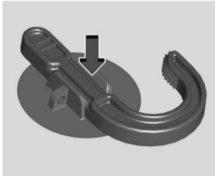
2. Empuje hacia abajo en el otro lado del gancho del piso de carga para bloquear en su lugar.
