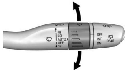
**AUTO (Automático):** Si está equipado con Rainsense, use este ajuste para pasadas intermitentes cuando Rainsense esté desactivado, o pasadas Rainsense cuando Rainsense esté activado. Para pasadas intermitentes, mueva la palanca del limpiaparabrisas a AUTO, luego gire la banda hacia arriba para pasadas más frecuentes, o hacia abajo para pasadas menos frecuentes. Si Rainsense está activado, vea "Rainsense" más adelante en esta sección.
