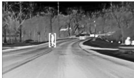
Con el sistema de Frenado delantero de peatones activado, la Visión nocturna proporciona una alerta roja en la Pantalla transparente (HUD), si está equipado, cuando el sistema detecta que el vehículo se está acercando muy rápido a un peatón o animal grande. Además, una alerta emite un pitido o el Asiento de alerta de seguridad pulsa, si está equipado. Consulte *Sistema de frenado ante peatón al frente (FPB)* ⇨ 260.
