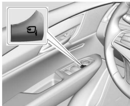
Si está equipado, presione
