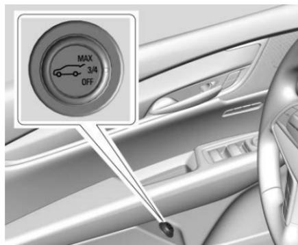
Si está equipado, el interruptor de la puerta trasera está en la puerta del conductor. El vehículo debe estar en P (estacionamiento).
