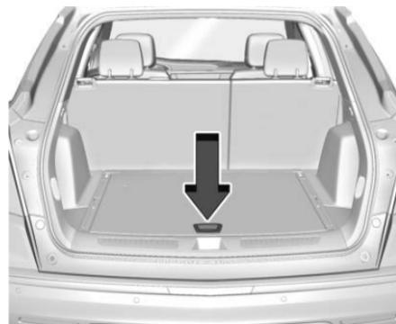
Hay almacenamiento en el piso del área de carga trasera. Levante la palanca para acceder.
