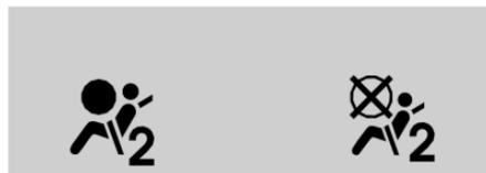
Cuando se arranca el vehículo, el indicador de estado de la bolsa de aire del pasajero encenderá los símbolos para on (encendido) y off (apagado), durante varios segundos a modo de revisión al sistema. Entonces, después de varios segundos, el indicador de estado iluminará el símbolo de encendido o apagado, para informarle el estado de la bolsa de aire exterior del pasajero.
