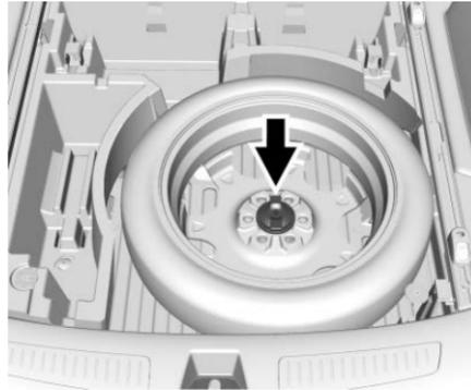
5. Retire la tuerca que sujeta la llanta de refacción.
