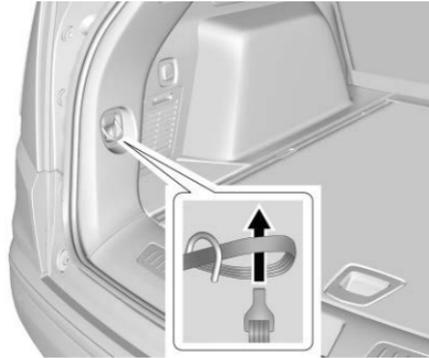
4. Coloque el extremo del lazo de la correa a través de la atadura de carga. Coloque el extremo del gancho de la correa a través del lazo y jálelo hasta que la correa esté sujeta con seguridad a la atadura.
