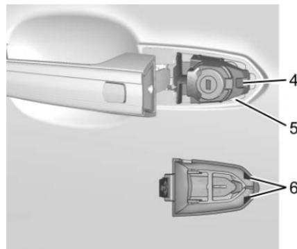
2. Inserte las dos lengüetas (6) en la parte trasera de la tapa entre el sello (5) y la base de metal (4).
