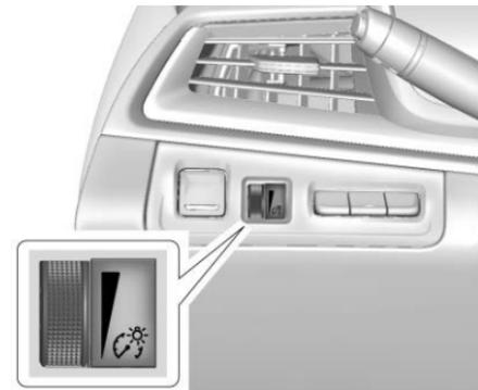
Esta función ajusta el brillo de todos los controles iluminados. Esta función está en el lado izquierdo del tablero de instrumentos.
