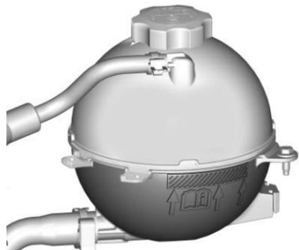
1. Con un sistema frío, desconecte la línea de ventilación del puerto cerca de la tapa del tanque de compensación. Agregue refrigerante a la marca indicada en el tanque de compensación.
