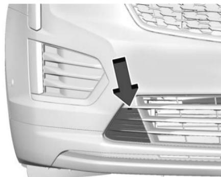
3. Retire la cubierta del conector del calentador del motor haciendo palanca suavemente con una herramienta de punta plana.
