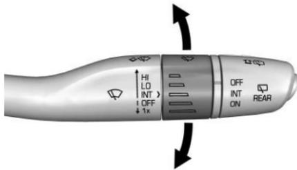
**INT:** Si está equipado sólo con pasadas intermitentes, mueva la palanca del limpiaparabrisas a INT. Gire la banda hacia arriba para limpiezas más frecuentes o hacia abajo para limpiezas menos frecuentes.
