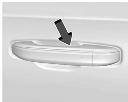
Apriete el interruptor en el área de sujeción interior de la manija de la puerta para operar la puerta de forma eléctrica cuando la llave remota esté dentro del rango o cuando el vehículo esté desbloqueado.
