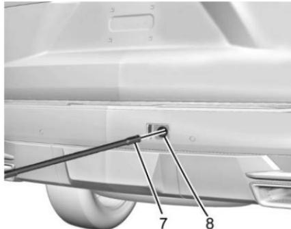
4. Inserte el extremo abierto de la extensión (7) a través del orificio que se encuentra en la defensa trasera (8) (orificio de acceso a la flecha del elevador).
