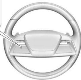
➊ : Si esta equipado, presione para prender o apagar el volante de dirección con calefacción. Se ilumina un indicador junto al botón cuando la función está encendida.
