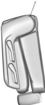
3. Levante la palanca de nuevo para liberar la parte trasera del asiento del piso. El asiento se abatirá hacia delante.
