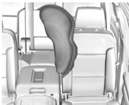
La bolsa de aire central delantera está en el lado interno del respaldo del conductor.
