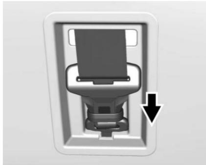
5. Deslice el seguro pequeño por el sujetador localizado en la capota interna.
