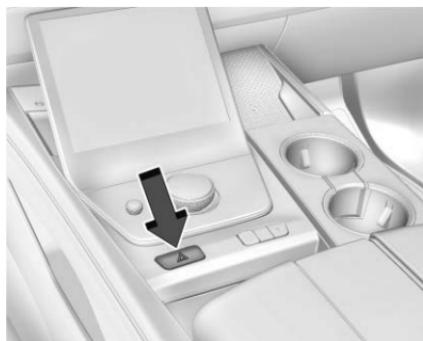
Oprima el botón para hacer que las luces direccionales delanteras y traseras parpadeen intermitentemente. Esto advierte a otros que usted está teniendo problemas. Presione nuevamente para apagar las intermitentes.
