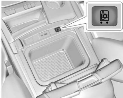
Si está equipado con un refrigerador/congelador de consola central, levante el descansabrazos para tener acceso. Una luz se encenderá cuando el descansabrazos esté arriba.
