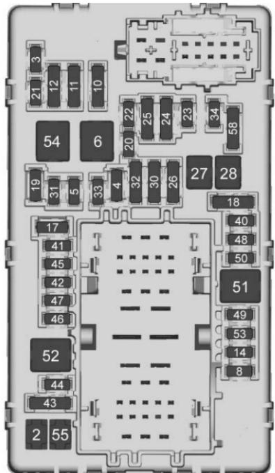
Hay relevadores en la parte trasera del bloque de fusibles. Para tener acceso a ellos, presione las lengüetas y retire el bloque de fusibles.
