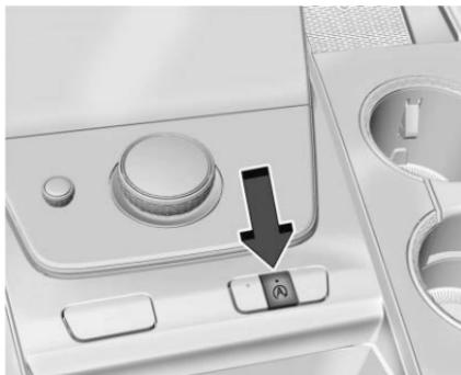
La función de paro/arranque automático se puede desactivar y activar presionando A. El Paro/arranque se activa cada vez que arranca el vehículo.
