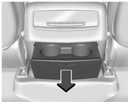
Si está equipado con portavasos en la consola central trasera, presione la cubierta y libere para tener acceso. Pueden haber dos puertos USB, dos puertos HDMI, y un tomacorriente en la parte trasera de la consola central.
