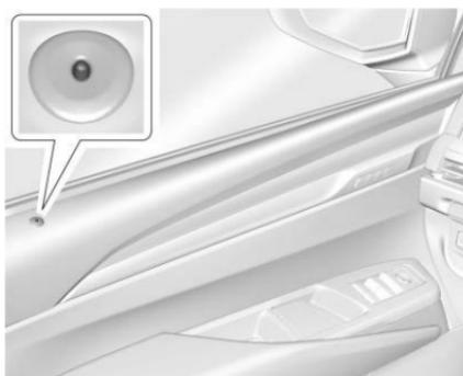
La luz, en la puerta del conductor cerca de la ventana, indica el estado del sistema.
