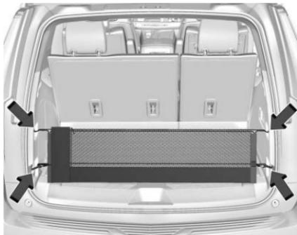
Este vehículo puede contar con una red de conveniencia en la parte trasera del vehículo. Fíjela a los amarres para carga para guardar cargas pequeñas.
