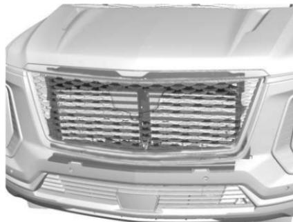
Este vehículo puede tener un sistema de obturador que cierra automáticamente la abertura de enfriamiento frontal. Este sistema está diseñado para ayudar a mejorar la economía del combustible. Asegúrese que el sistema de obturador esté libre de cualquier desechos, nieve o hielo.
