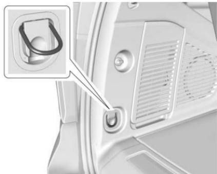
Hay dos amarres de carga en el área de carga trasera. Estos se pueden usar para amarrar la carga y evitar que se mueva dentro del vehículo.
