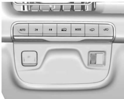
Si está equipado, los controles de la caja de transferencia se usan para cambiar a y desde tracción en las cuatro ruedas.
