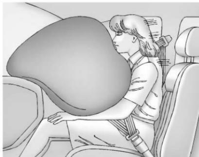
La bolsa de aire delantera del pasajero exterior está en el lateral del tablero de instrumentos.
