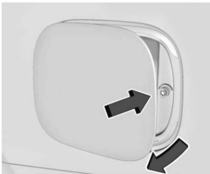
Para abrir la puerta del combustible, presione y suelte el borde central hacia atrás de la puerta.
