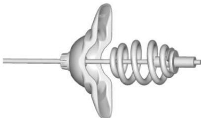
Incline el dispositivo de retención y jálelo así como el cable y el resorte a través del centro de la rueda.
