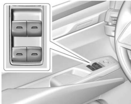
Las ventanas eléctricas funcionan cuando el vehículo está encendido, en modo de accesorios, o cuando la Energía retenida para los accesorios está activa. Consulte *Energía retenida para los accesorios (RAP)* ▷ 226.
