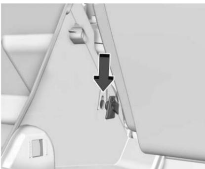
3. Desconecte el amortiguador de cadena para retirar completamente la bandeja de la guantera.
