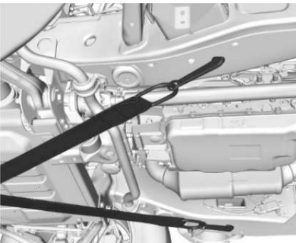
El vehículo está equipado con puntos de conexión específicos que se usarán para jalar el vehículo sobre una grúa de plataforma plana desde una superficie de camino plana. No utilice estos puntos de conexión para jalar el vehículo de nieve, lodo, o arena.
