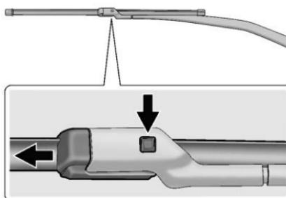
2. Oprima el botón que está en medio del conector del brazo del limpiador y tire de la pluma del limpiador hacia fuera del conector del brazo.
