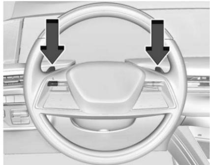
La Selección electrónica de rango, o Modo Manual, permite la selección del rango de posiciones de las velocidades. Utilice este modo al conducir en una pendiente hacia abajo o al jalar un remolque para limitar la velocidad del vehículo y el cambio más alto. El indicador de posición de cambio dentro del Centro de información del conductor mostrará un número junto a la letra L que indica la mayor velocidad disponible.
