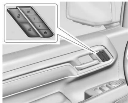
Si está equipado, la función de asiento con memoria permite que los conductores guarden sus posiciones de conducción únicas y una posición para salir compartida. También se pueden guardar otras posiciones de función, tales como los espejos eléctricos.
