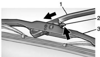
2. Empuje la palanca de liberación (2) para desacoplar el gancho y empuje el brazo del limpiador (1) hacia fuera del ensamble de la pluma (3).
