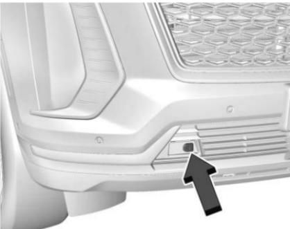
4. Conecte el cable del calentador en el conector en la defensa delantera.
