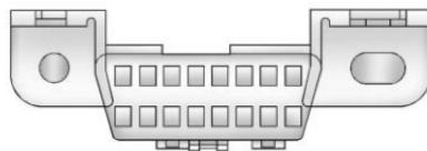
El Conector de enlace de datos está debajo del tablero de instrumentos del lado izquierdo del volante. Conectar dispositivos que no se utilicen para realizar una Inspección de emisiones/Prueba de mantenimiento o para dar servicio al vehículo puede afectar la operación del vehículo. Vea *Equipo eléctrico incorporado* ▷ 320. Visite a su distribuidor si necesita asistencia.
