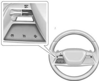
: Presione para encender o apagar el control de velocidad constante. Cuando ACC es el modo de control de velocidad constante seleccionado, la luz de ACC se ilumina en blanco en el grupo de instrumentos.
