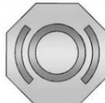
El depósito del cilindro maestro de frenos se llena con líquido de frenos DOT 4 aprobado por GM, como se indica en el tapón del depósito. Vea en *Vista general del compartimiento del motor* ▷ 326 la ubicación del depósito.
