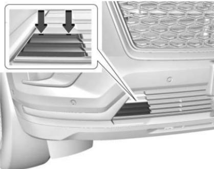
3. Retire la cubierta del conector del calentador del motor haciendo palanca suavemente en la muesca pequeña con una herramienta de punta plana.
