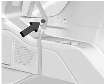
6. Guarde el cinturón de seguridad en el sujetador de almacenamiento del cinturón. Repita los pasos para doblar el otro respaldo, si lo desea.
