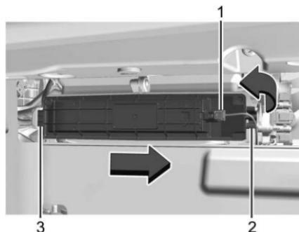
4. Desconecte el cable eléctrico (1) en el lado derecho de la puerta de filtro, desconecte la puerta y jale hacia afuera (2), y después desconecte desde el lado izquierdo (3) para retirar la puerta. Retire el filtro anterior.
