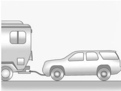
Sólo realice arrastres con remolque en vehículo con tracción en las cuatro ruedas que cuente con caja de transferencia de dos velocidades y que tengan configuración N (neutral) y 4 ↓.
