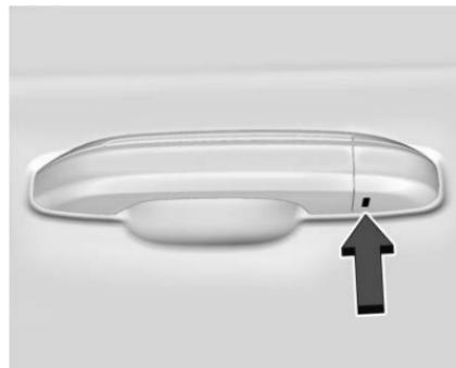
2. Inserte la llave mecánica en la ranura en la parte inferior de la manija y jale hacia arriba completamente hasta que la cubierta se libere. No haga palanca o jale sobre la llave.
