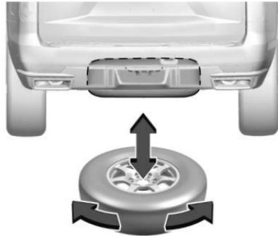
7. Cerciórese de que la llanta quede guardada de manera segura. Empuje, jale la llanta
