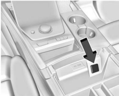
El vehículo tiene un tomacorriente para accesorios dentro de la consola central. Levante la cubierta para acceder y reemplazar cuando no esté en uso.
