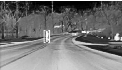
Con el sistema de Frenado delantero de peatones activado, la Visión nocturna proporciona una alerta roja en la Pantalla transparente (HUD), si está equipado, cuando el sistema detecta que el vehículo se está acercando muy rápido a un peatón o animal grande. Además, una alerta emite un pitido o el Asiento de alerta de seguridad pulsa, si está equipado. Consulte *Sistema de frenado ante peatón al frente (FPB)* ▷ 300.
