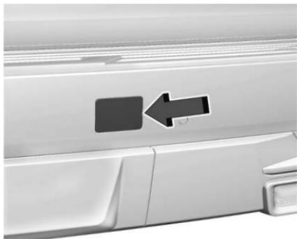
1. Abra la cubierta del seguro de la llanta de la refacción en la defensa y use la llave mecánica para retirar el seguro de la llanta de refacción (6). Para retirar el seguro de la llanta de refacción inserte la llave mecánica, gírela, y jale en sentido recto hacia fuera.
