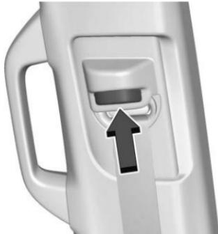
Presione el botón de liberación para mover el ajustador de altura a la posición deseada.
