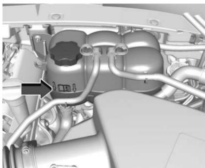
Revise si se alcanza a ver refrigerante en el tanque de compensación del refrigerante. Si el refrigerante que está dentro del tanque de compensación del refrigerante está hirviendo, espere hasta que se enfrie. El nivel del
