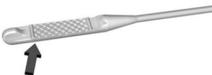
Si el aceite está debajo del área sombreada en la punta de la varilla de medición y el motor ha estado apagado durante por lo menos 15 minutos, agregue 1 L (1 qt) del aceite recomendado y después vuelva a verificar el
