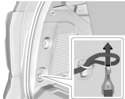
4. Retire la llanta ponchada, asegure la correa de la guantera y coloque el extremo del lazo de la correa a través del amarre de carga. Coloque el extremo del gancho de la correa a través del lazo y jálelo hasta que la correa esté asegurada firmemente al amarre.
