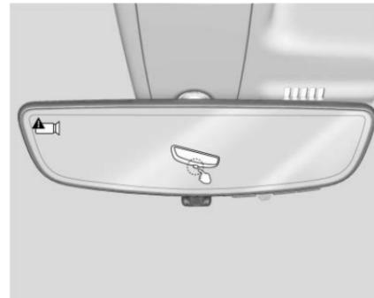
Consulte a su distribuidor para servicio su se muestra una pantalla azul y en el espejo, y la pantalla se apaga. Además, empuje la lengüeta como se indica para regresar al modo de atenuación automática.
